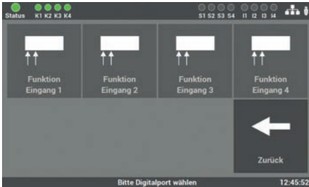
Abb. 105: Maske „Ein-/Ausgänge – potenzialfreie Steuereingänge“
