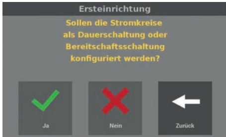
Abb. 43: Abfrage nach Schaltungsart
