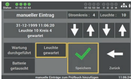
Abb. 67: Maske „Manuelle Dokumentation – Wartung Leuchten“
