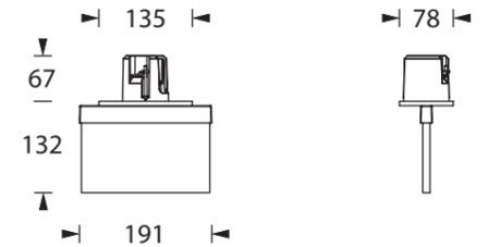
Deckeneinbaumontage / Recessed ceiling mounting / Montage encastré au mur
