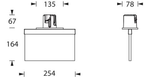
Deckeneinbaumontage / Recessed ceiling mounting / Montage encastré au mur
