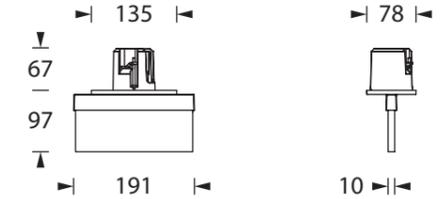
Deckeneinbaumontage / Recessed ceiling mounting / Montage encastré au mur
