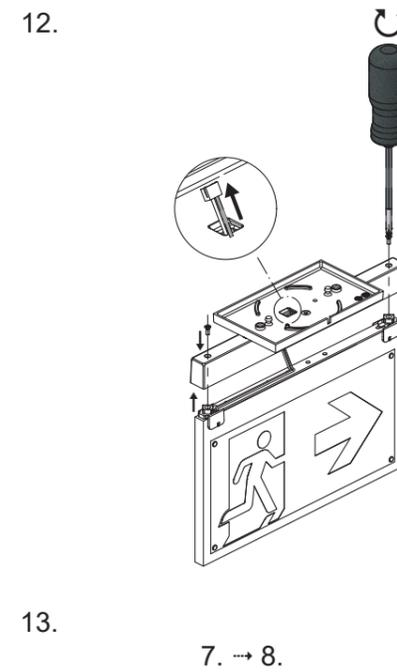
Deckeneinbaumontage / Recessed ceiling mounting / Montage encastré au mur
